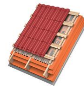
Теплоизоляция между стропил
